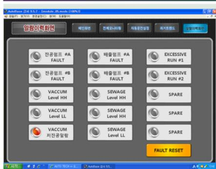
레벨의 수위 및 펌프의 FAULT 등의 신호를 모니터링하여 사용자가 인지할 수 있도록 화면에 표시 한다.
