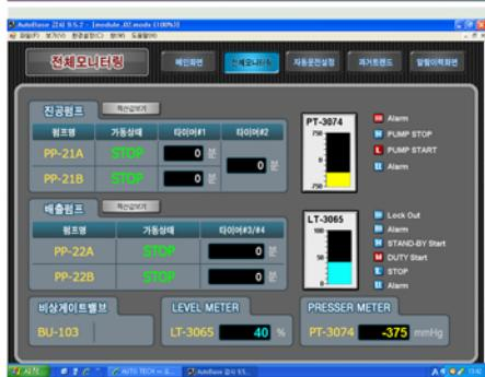
폐수이송 시스템의 설비 전체의 상태를 모니터링 할 수 있는 화면으로써 한눈에 시스템상태 확인이 가능 하다.
