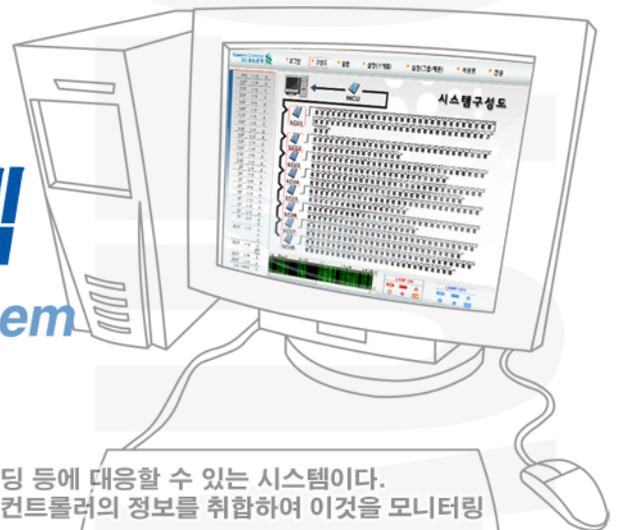
이 시스템은 오피스, 점포, 스포츠센터 등 여러가지 용도, 공간이 공존하는 빌딩 등에 대응할 수 있는 시스템이다. 중앙제어 시스템에서 네트워크망을 통해 조명의 제어 뿐만 아니라 각 조명제어 컨트롤러의 정보를 취합하여 이것을 모니터링 및 조명의 효율적 제어가 가능하다. 이러한 기능을 통해 각 료의 전등 ON/OFF 상태를 관제하고 각 때에 따라 스케줄 패턴제어가 가능하여 전력-소비량-조절 기능을 수행할 수 있다.
