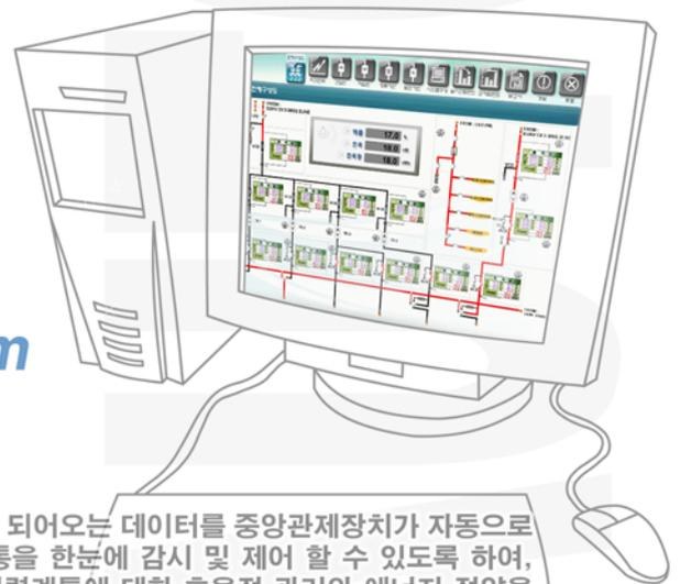
전기시설물(배전반, 변압기, 발전기 등)로부터 전송(T/D, 전자식 디지털 계전기)되어오는 데이터를 중앙관제장치가 자동으로 수집하고 분류, 분석하여 모니터상에 표시함으로써 공장 또는 건물의 전력계통을 한눈에 감시 및 제어할 수 있도록 하여, 특정상황에 대한 조치 및 조작을 신속히 수행함으로써 사고의 미연방지 및 전력계통에 대한 효율적 관리와 에너지 절약을 목적으로 설치되는 시스템이다.
