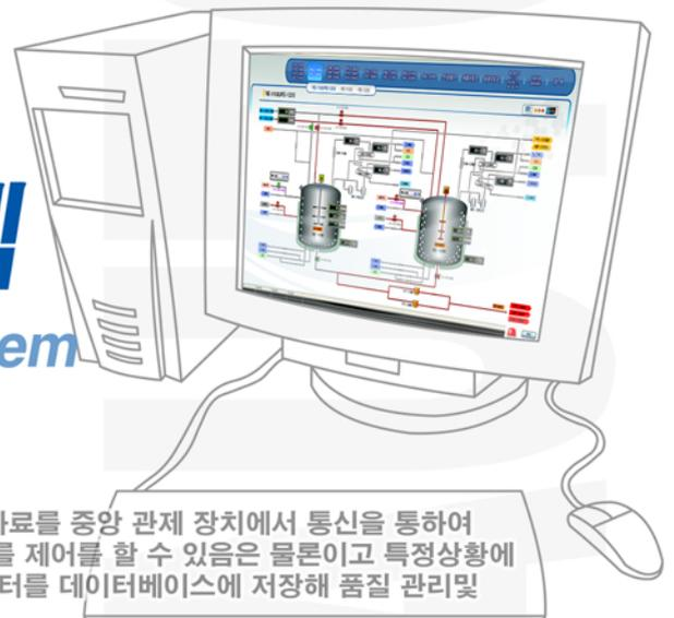
공정 모니터링 시스템은 원거리에 분포되어 있는 PLC, CONTROLLER 의 자료를 중앙 관제 장치에서 통신을 통하여 수집하여 분석 관리하고 기계설비의 가동 상태를 표시하며 기계의 운전, 정지를 제어할 수 있음은 물론이고 특정상황에 대한 조치 및 조작을 신속히 수행함으로써 사고의 미연 방지와 기계 성능 데이터를 데이터베이스에 저장해 품질 관리 및 기계의 효율을 향상시키는 시스템이다.
