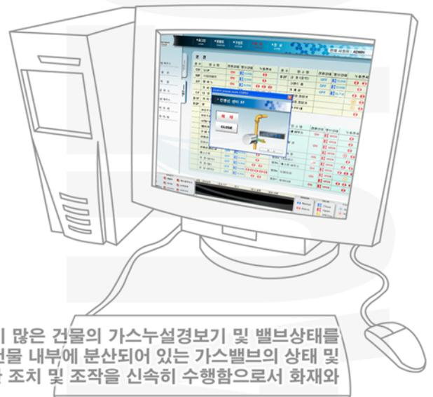
호텔이나 식당이 많이 밀집되어 있는 백화점 등의 가스누설로 인한 화재요인이 많은 건물의 가스누설경보기 및 밸브상태를 중앙관제장치가 자동으로 수집하고 분류, 분석하여 모니터상에 표시함으로써 건물 내부에 분산되어 있는 가스밸브의 상태 및 가스누설경보 내용을 한눈에 감시 및 제어 할 수 있도록 하여, 특정상황에 대한 조치 및 조작을 신속히 수행함으로써 화재와 폭발을 미연방지 하여 방재 관리를 목적으로 설치되는 시스템이다.
